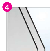
Vitrage 4/16/4 faible émissivité + argon + warm edge, Ug = 1,1
