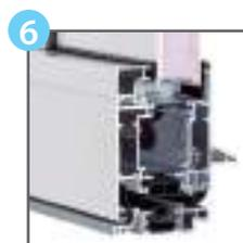
Rupture thermique réalisée sur les dormants et les ouvrants par 2 barettes polyamides, renforcées de fibre de verre, diminuant l'effet bilame
