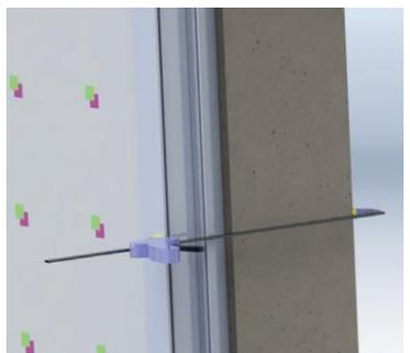
**8** Solidariser la nouvelle menuiserie avec vis auto-forieuse de rénovation.
