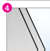
Vitrage 4/20/4 faible émissivité + argon + warm edge, Ug = 1,1
