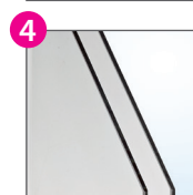
Vitrage 4/20/4 faible émissivité + argon + warm edge, Ug = 1,1
