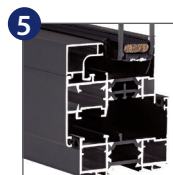
Profil à rupture de pont thermique par 2 barettes polyamides renforcées de fibre de verre
